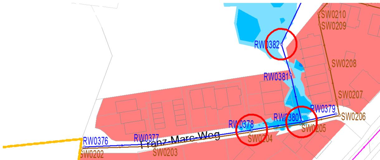
Abbildung 5.2: Schachtüberstau im Bereich des Franz-Marc-Wegs bei einer Wiederkehrzeit von  $T = 3$  und  $5$  Jahren (Quelle: GEP)
